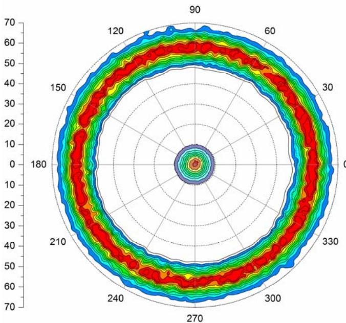
Полюсная фигура для отражений (0002) и (11-22) слоя **GaN** на **поликоре**. Осевая текстура (0001) с углом разориентации оси (001)  $\Delta\omega = 10^\circ$  и изотропным распределением ориентаций (10-10) и (01-10) в плоскости
