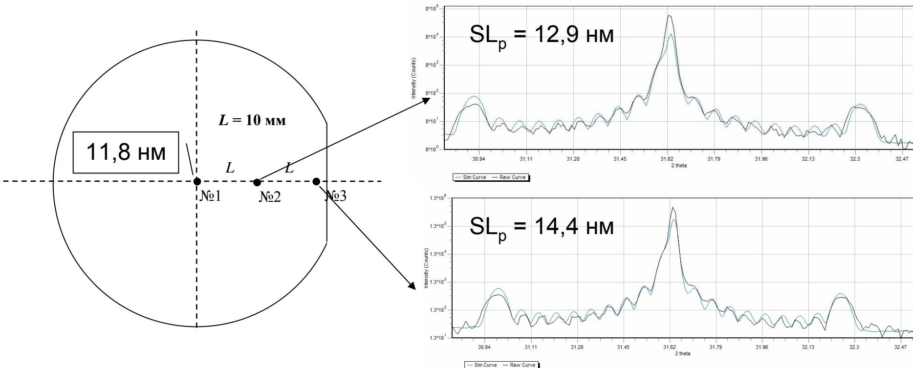
Спектр сателлитных пиков вблизи отражения (002) GaAs для сверхрешетки 10x[AlGaAs/GaAs]. Спектры дифракции регистрировались еще в 2 точках – с отступом 10 мм от центра к краю с базовым срезом. К краю структуры период СР растет.
