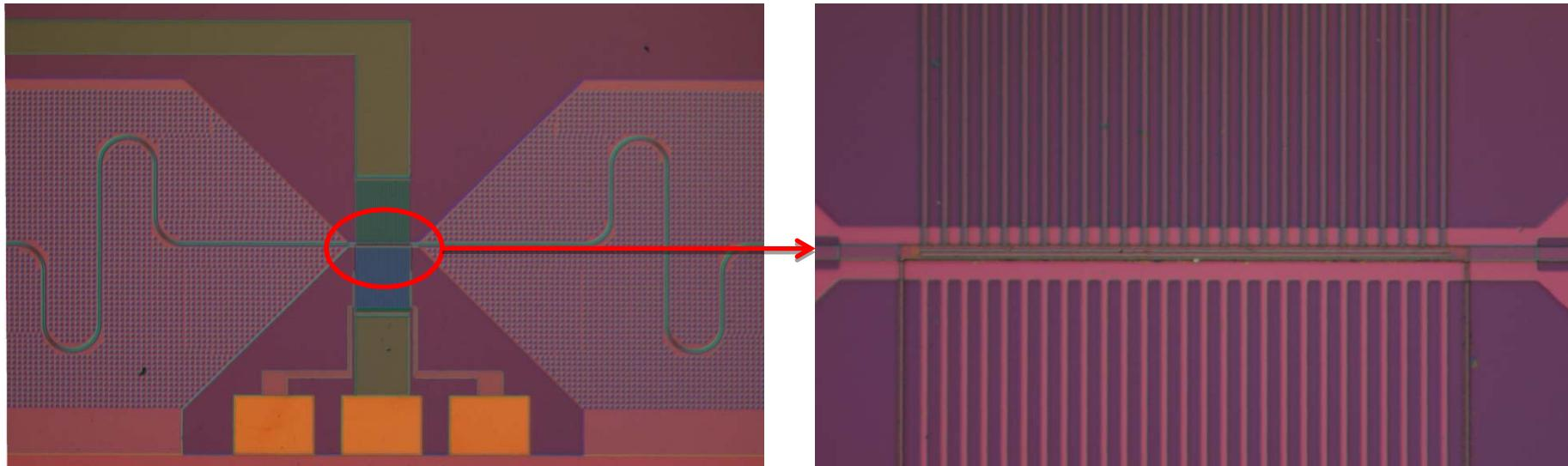
Токовые электроды выполнены в виде тонких «пальцев» чтобы обеспечить изоляцию от микроволнового излучения и создать равномерное распределение тока через переход.
