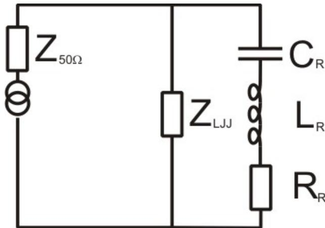
Чтобы согласовать планарный резонатор со встроенным длинным Джозефсоновским переходом с  $50\ \Omega$  внешней линией необходимо выполнить следующее условие на добротность резонатора  $Q_R$  и сам импеданс перехода.
