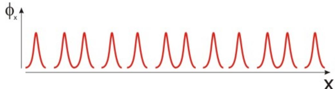
Полезный сигнал переносится модуляцией плотности вихрей
