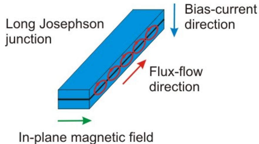
«Flux-flow» частота излучения чрезвычайно высока – от 100 ГГц до 1.4 ТГц
