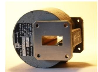
Изолятор – невзаимное устройство, с несимметричной матрицей рассеяния. Идеальный изолятор передает всю мощность с порта 1 на порт 2, но поглощает всю мощность входящую с порта 2.
