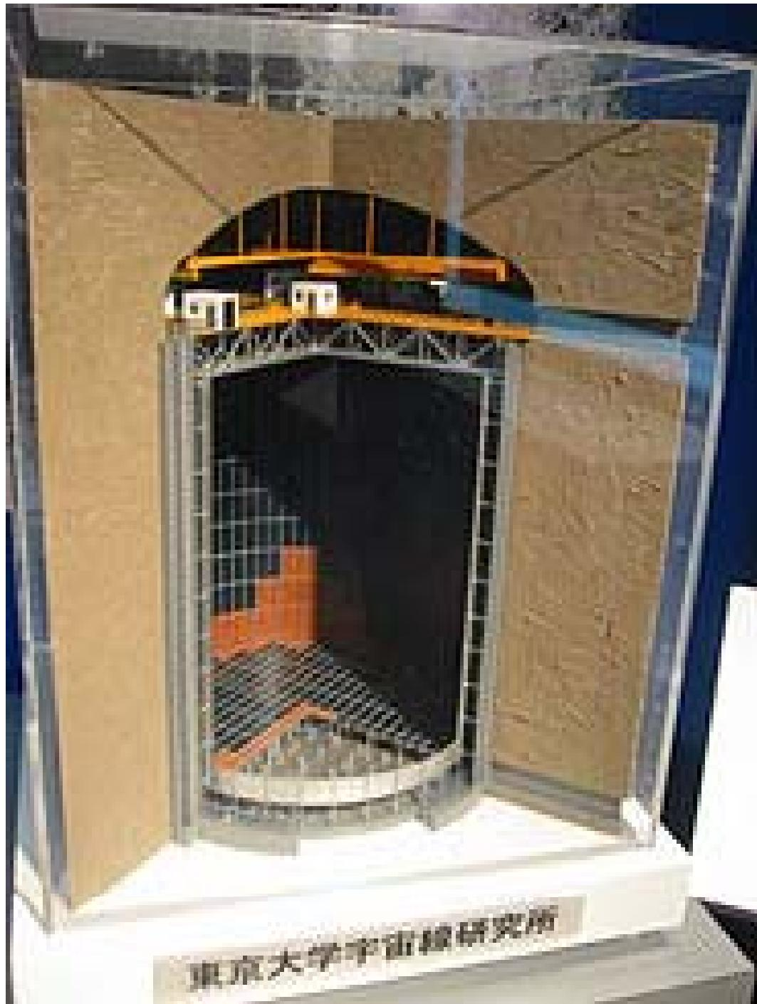
Детектор **Super-Kamiokande** представляет собой резервуар из нержавеющей стали высотой 42 м и диаметром 40 м, заполненный 50 тыс. тонн специально очищенной воды. На стенах резервуара размещены 11146 фотоумножителей.
